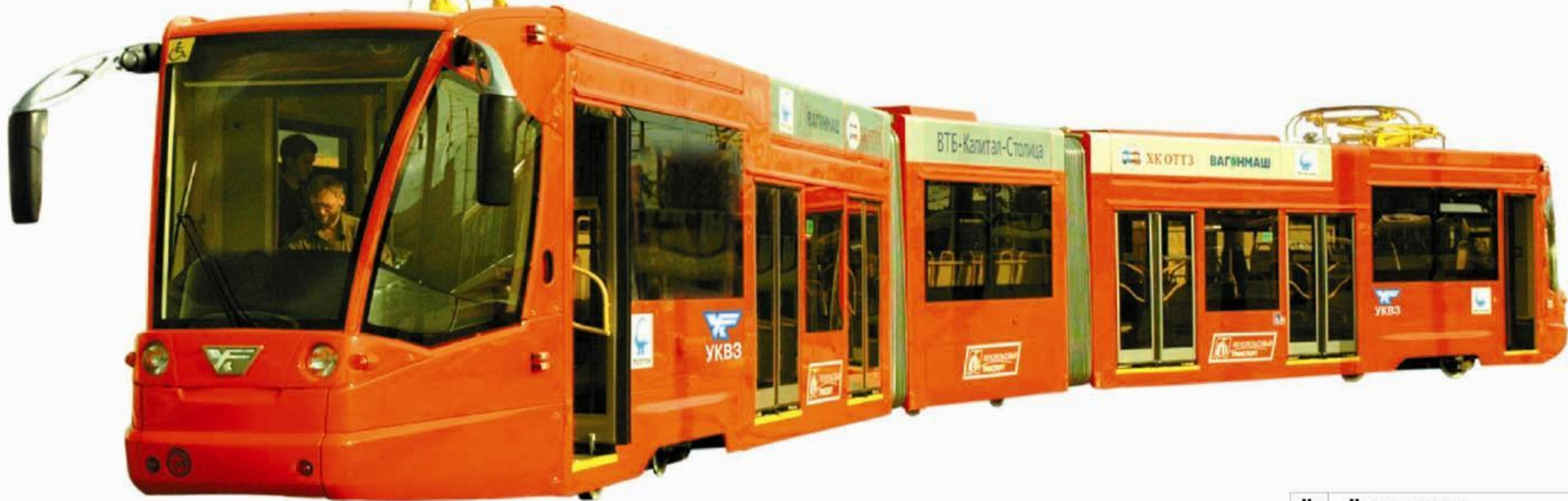
Первый шестисекционный трехсекционный шарниро-сочлененный трамвайный вагон модели «71-630 А» с низким уровнем пола, двустороннего движения спроектирован и изготовлен на Усть-Катавском вагоностроительном заводе, имеет модульную конструкцию кузова, является родоначальником нового модельного ряда трамваев 4-х, 6-ти и 8-ми осных длинной от 16 до 38 метров.
