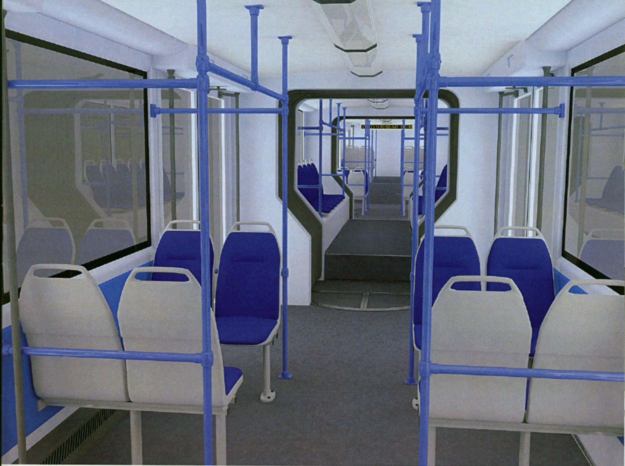
Использование передовых технологий при создании интерьера салона обеспечивает комфорт, и привлекательность вагона для пассажиров. В основе интерьера — формованные панели из стеклопластика. Технология установки и конструктивные особенности данных панелей исключают наличие видимого крепежа. Освещение салона производится «световой линией» на базе люминесцентных ламп. Напольное покрытие гармонирует с общим решением интерьера. В вагоне установлены новые оригинальные кресла для пассажиров.
