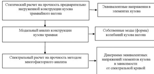
Рисунок 1 — Схема поэтапного динамического расчета на прочность кузова трамвайного вагона
