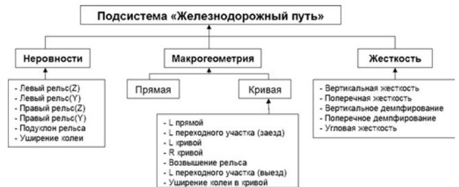
**Рисунок 7 — Схема подсистемы «Железнодорожный путь»**
