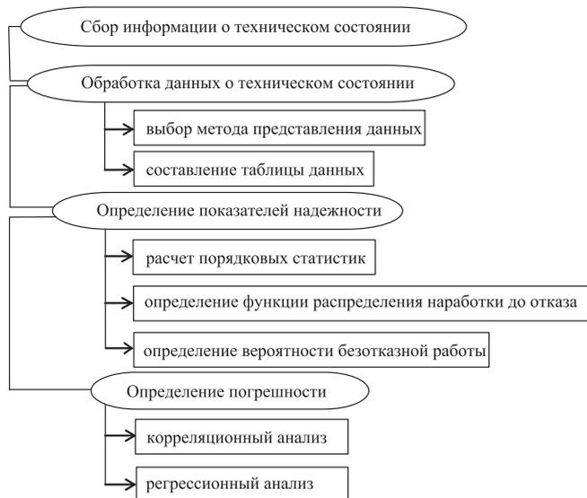
Рисунок 1 – Методика прогнозирования надежности трамвайного вагона по данным об отказах в эксплуатации
