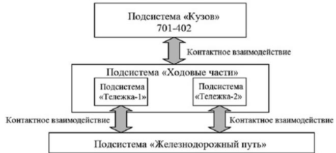
Рисунок 2 — Общая схема математической модели трамвайного вагона
