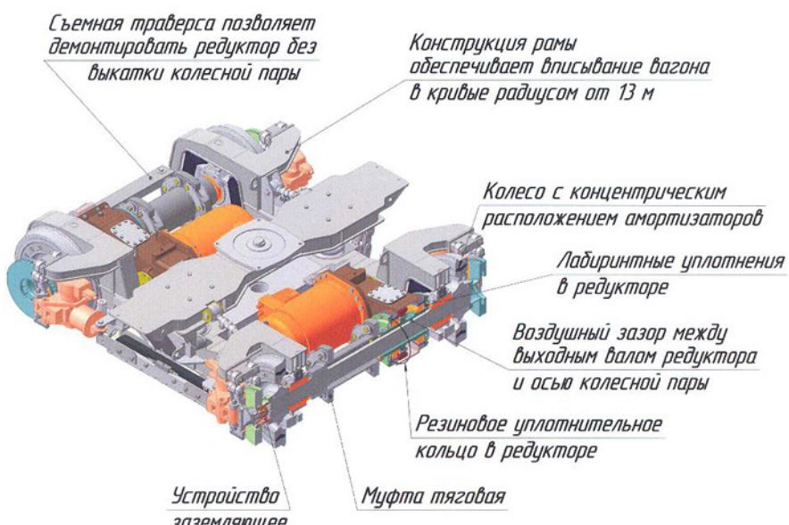
Параллельно пружинам и резинометаллическим амортизаторам установлены наклонные гидравлические гасители колебаний, которые улучшают комфортность проезда пассажиров. Тяговые усилия от рамы тележки на шкворневую балку или раму средней секции передаются поводками. Остальные узлы конструкции тележек полностью идентичны.
